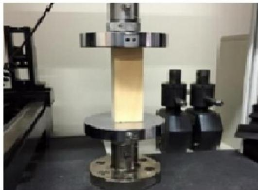
Forma de colocar la probeta para compresión paralela al grano
