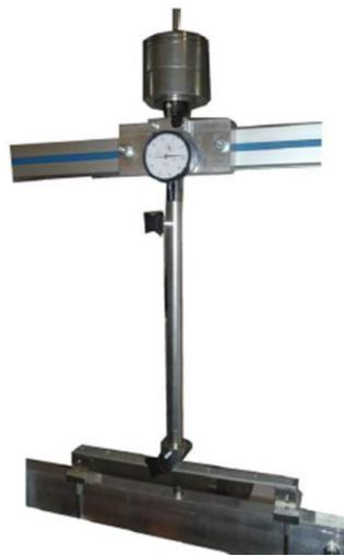
Se muestra la configuración para ensayo a flexión.
